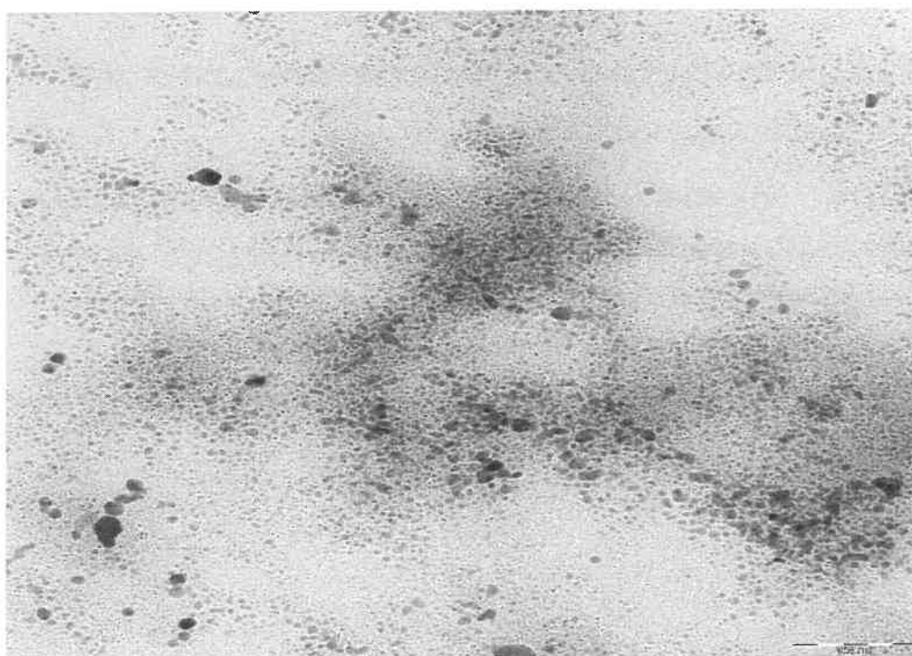
Rysunek 47 Obraz TEM nanocząstek srebra stabilizowanych PVA.
