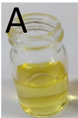
Rysunek 13. Rysunek koloidu nanocząstek srebra stabilizowanych boranami przed dodatkiem ekstraktu z pleśni (A) i po dodatku ekstraktu z pleśni (B).
