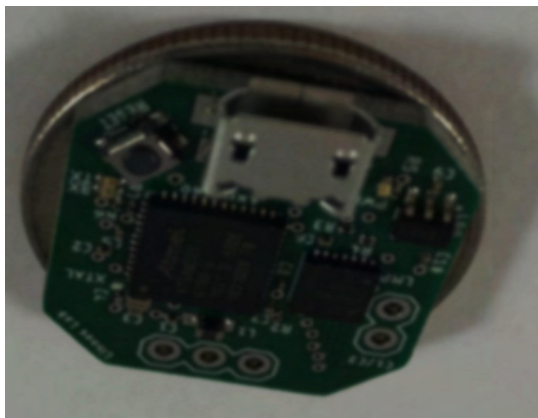
Rysunek 100. Mikrokontroler SAMD21 z wbudowanym przetwornikiem cyfrowo-analogowym [26].
