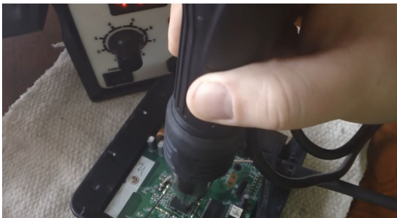
Rysunek 105. Przykładowy pomiar stabilności układu z wykorzystaniem nagrzewnicy HOT-AIR
