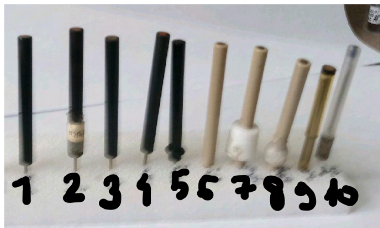
Rysunek 31. Widok elektrod z węgla szklistego modyfikowanych nanocząstkami złota stabilizowanymi anionami fosfododekamolibdenianowymi wbudowanymi w warstwy polimerów przewodzących (polianiliny oraz polipirolu) lub zespolonych polimerem protonoprzewodzącym Nafionem.
