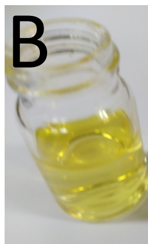
Rysunek 13. Rysunek koloidu nanocząstek srebra stabilizowanych boranami przed dodatkiem ekstraktu z pleśni (A) i po dodatku ekstraktu z pleśni (B).
